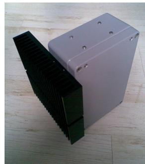
In jedem Strombegrenzungsstrang sind zwei LeistungsMosFets mit integrierter Strommessung und den entsprechenden Schutz- und Freilaufdioden. Jeder LeistungsMosFet ist, mit seinen Dioden, auf einem Kühlkörper montiert.
